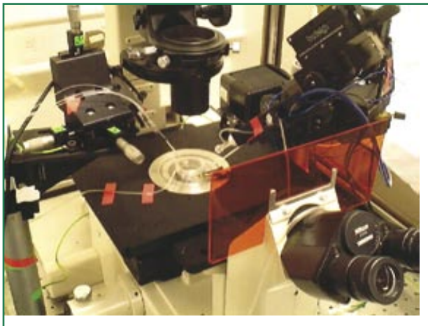
Aparat, ki se ga uporablja za merjenje majhnih električnih potencialov, ki se vzpostavljajo v sinapsah.
