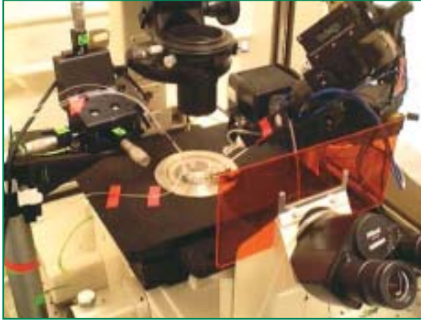
シナプスに発生する微小電位の観察に用いられる装置。
