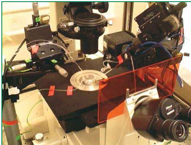
อุปกรณ์ใช้สำหรับวัดความต่างศักย์ไฟฟ้าค่าต่ำๆ ที่เกิดขึ้นที่จุดประสานประสาท
