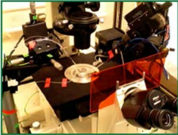
Aparato que se utiliza para detectar los pequeños voltajes eléctricos que ocurren durante una sinapsis.
