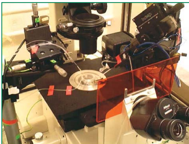
Аппарат для мониторинга крошечных электрических напряжений, регистрируемых в синапсах.
