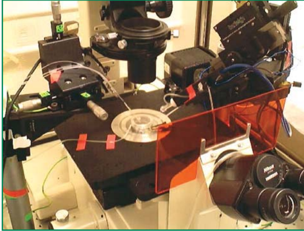
Συσκευή για την καταγραφή των μικροσκοπικών ηλεκτρικών τάσεων που παρατηρούνται στις συνάψεις.
