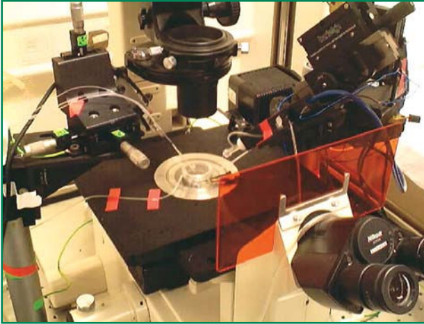
Aparatura koja se koristi za praćenje malih električnih napona, koji se javljaju u sinapsi.
