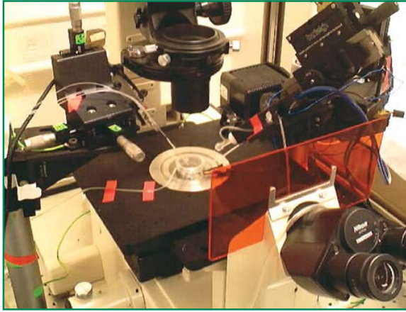
جهاز يسجل الجهد الكهربى الدقيق فى المشابك
